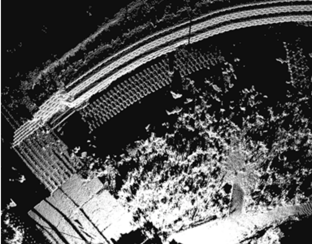
図9 スキャン型レーザー画像によるグリッド型三次元モデル
