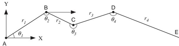
点  $A$  において計測された距離と角度から、点  $B$  と点  $A$  の座標の差  $(\Delta x_1, \Delta y_1)$  と点  $B$  の座標  $(x_b, y_b)$  は、以下のように計算できる。
