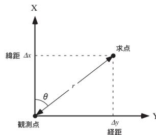
上図を見ても解るように、注意すべきは、 $x$  座標が上方で、 $y$  座標が右方向となっており、数学で通常慣れ親しんだ座標系ではない。いわゆる左手系の座標系となっている。これは、後述する地図投影における座標系が横メルカトル図法を基準としているため、測量においてはこの座標系が採用されている。この座標系において、方位角  $\theta$ 、距離  $r$  のときの緯距と経距は、下の式で計算できる。
