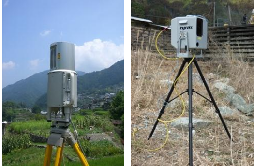
図3-1 LMS-Z210 Cyrax-2500 LiDARの外観
