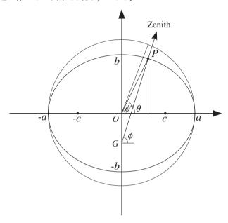
この天頂方向のベクトルは、楕円体上の P における**接平面** (tangential plane) の法線方向に等しい。したがって、地理緯度と地心緯度の関係を導くためには、楕円体上の法線ベクトルを求める計算からしなければならない。その後、点 P と点 G との距離を計算し、地理緯度  $\phi$  から点 P の座標を求めることができる。
