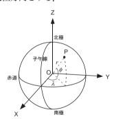
回転楕円体上の点 P の地理緯度が  $\phi$ , 経度が  $\lambda$  のとき, 点 P の三次元座標 (x,y,z) を求めたい, このとき, 点 P を y 軸回りに  $-\phi$  回転させて x-z 平面と一致させたときの点 P の座標は,  $(N\cos\phi,0,-\frac{b^2}{a^2}N\sin\phi)$  である. したがって, この座標を z 軸回りに  $+\lambda$  回転させて, 元の位置に戻せば良い. これを回転行列を用いて表すと, 以下のようになる.
